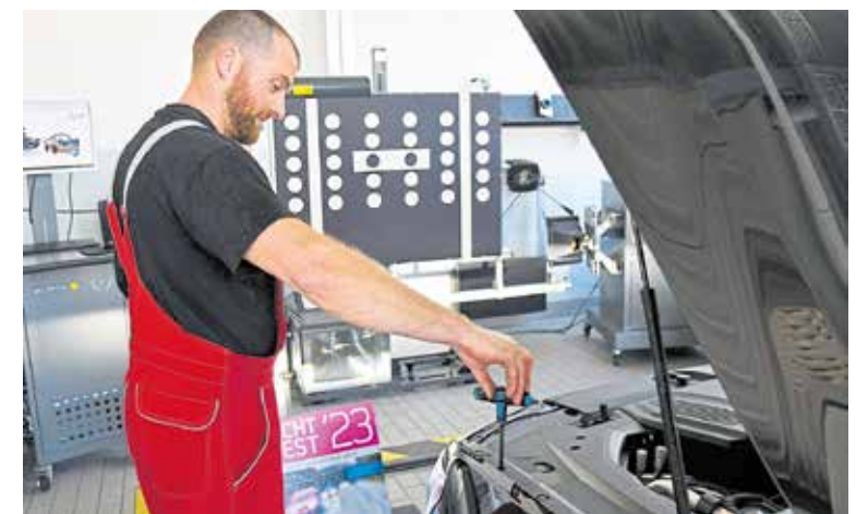
Mit einem Dreh hat Servicetechniker Carsten Jurich den Scheinwerfer richtig eingestellt.
